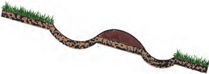
Figura 8.8 – Figura esquemática de um terraço tipo Manghum, de base larga, com detalhes da existência de dois canais e um camalhão com pequena altura para possibilitar o plantio tanto dos canais como do camalhão
