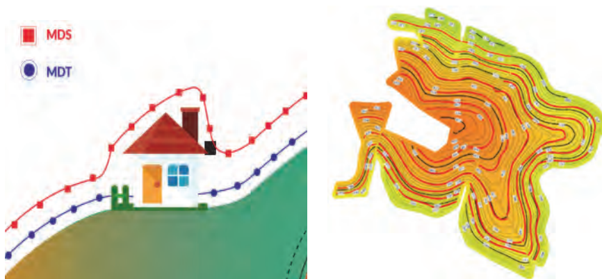
Figura 8.3 – Ortofoto de imagem aérea georreferenciada, capturada através de mapeamento com drones destacando o MDS e o MDT, úteis para gerar o mapa de niveladas ou de declive
