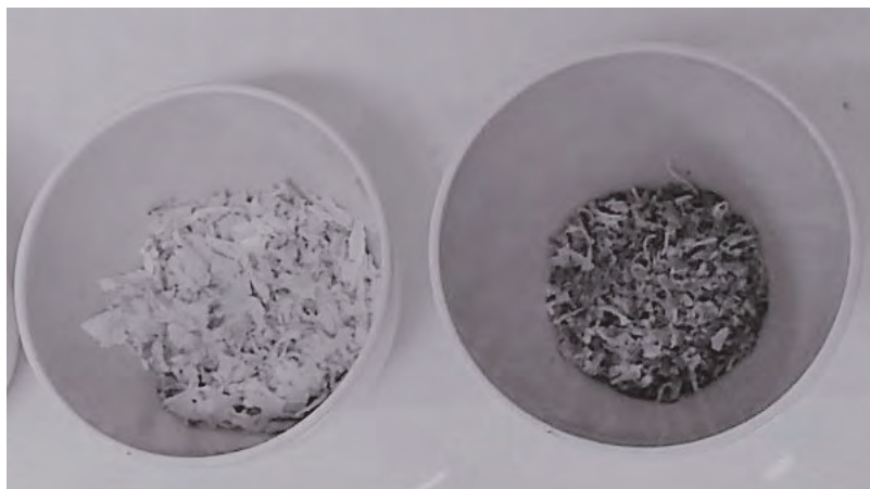
Figura 2.2 – Coloração das cinzas de duas espécies vegetais do Bioma Caatinga: Acalypha brasiliensis (cinza clara) e Campomanesia eugenioides (cinza escura), calcinadas em forno mufla a 500°C por duas horas.
